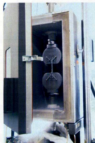
液体窒素による-100°C低温引張試験状況
