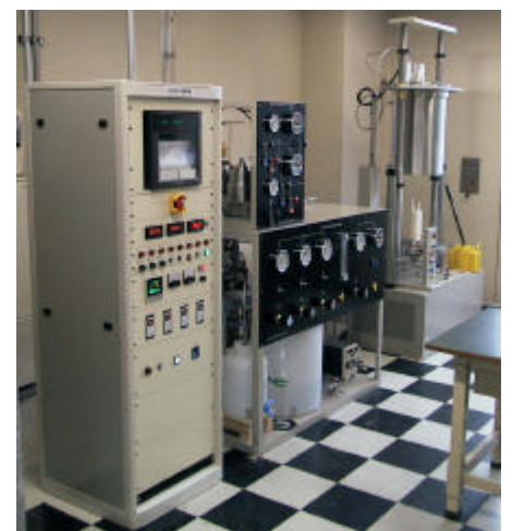
加圧水蒸気酸化試験装置全景
